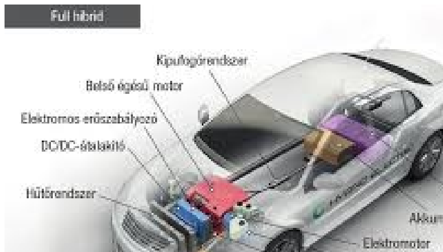
2. ábra: Hibrid jármű felépítése Forrás: Filipinovic, 2022
